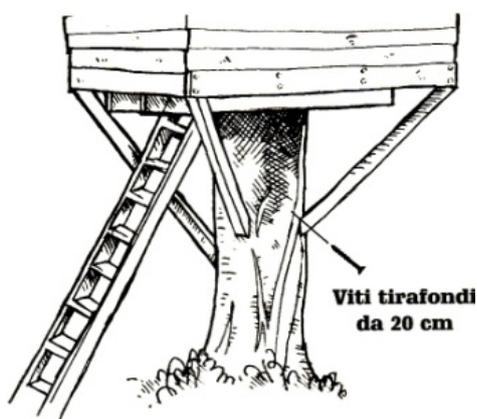
Ora bisogna fissare i quattro travetti diagonali al tronco mediante le otto viti tirafondi da 20 centimetri; forare i 10 centimetri del travetto in modo che altrettanti 10 centimetri entrino nell'albero.
