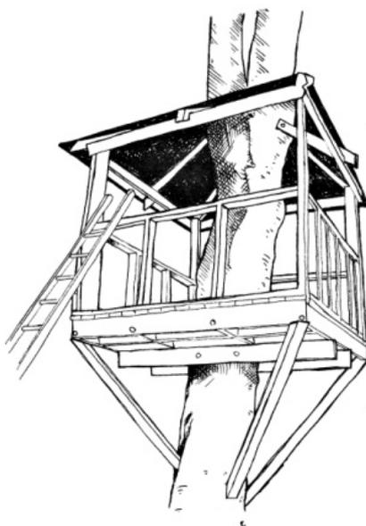
Ora bisogna ricoprire il tetto. Si consiglia di fissare una membrana di plastica alle travi, con chiodi a testa grossa, prima di ricoprire con tavole inchiodate. Ogni pezzo va tagliato a misura e poi fissato.
